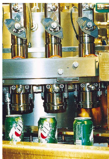
Linia do rozlewania napojów, do których dodano wcześniej CO 2 . Zakłady Napojów Gazowanych PEPSI COLI w Michrowie
