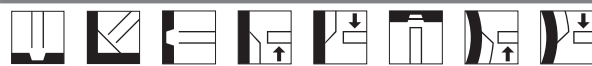
PA/1G PB/2F PC/2G PF/3G góra PG/3G dół PE/4G PF/5G góra PF/5G dół
