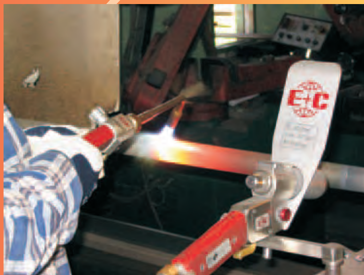
Natryskiwanie proszkowe na gorąco warstw odpornych na zużycie na rurach kotłowych
