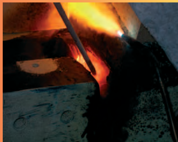
Odbudowa powierzchni wału szlifierki metodą natrysku proszkowego
