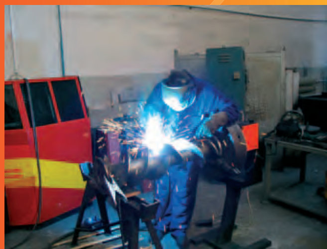
Napawanie metodą MIG/MAG
