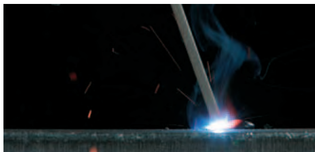
1) Elektroda otulona - 2) Otulina - 3) Rdzeń metalowy 4) Łuk elektryczny - 5) Atmosfera ochronna - 6) Jeziorko spawalnicze - 7) Żużel 8) Materiał napawany - 9) Materiał bazowy
