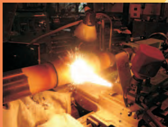
Odbudowa powierzchni wału szlifierki metodą natrysku proszkowego
