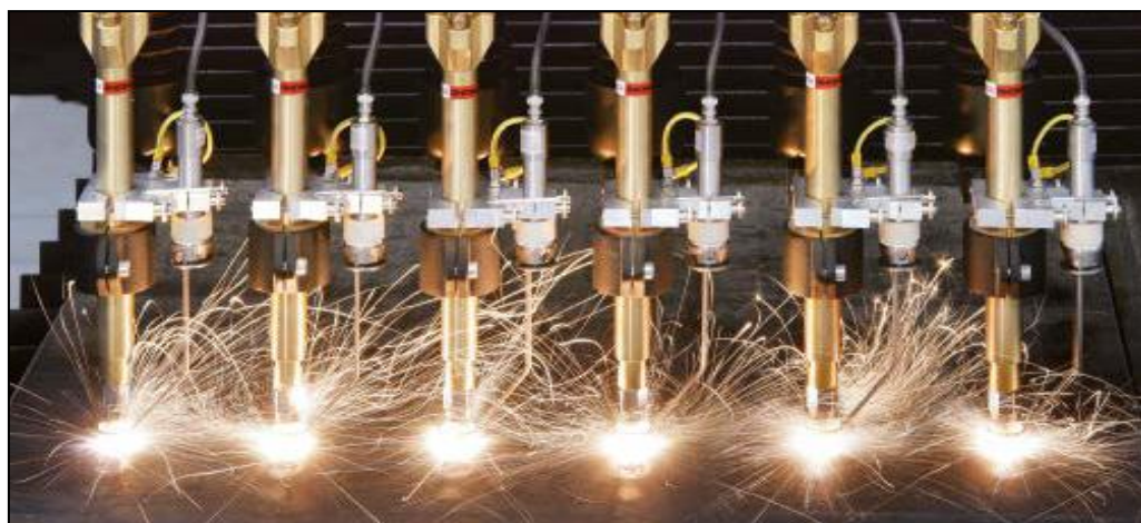
BIR+™ multi-palnik do przebijania otworów
