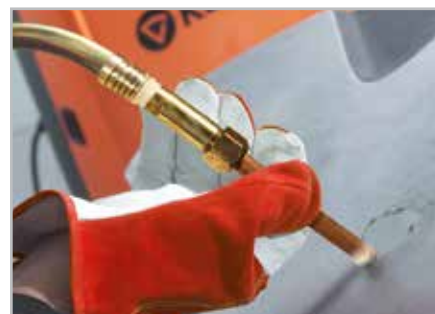
Dzięki funkcji HotSpot™ można łatwo i wygodnie kurczyć metal lub podgrzewać elementy.
