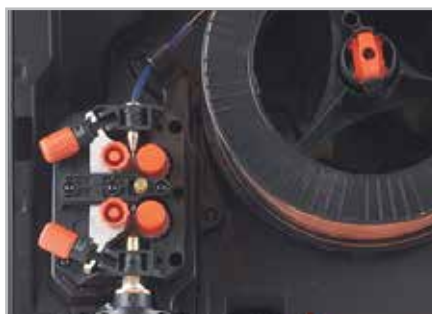
Modele Kempact 253/323 posiadają 4-rolkowy mechanizm podający DuraTorque.
